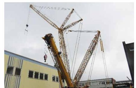
▲ Raupenkran Typ Demag CC-3800.
