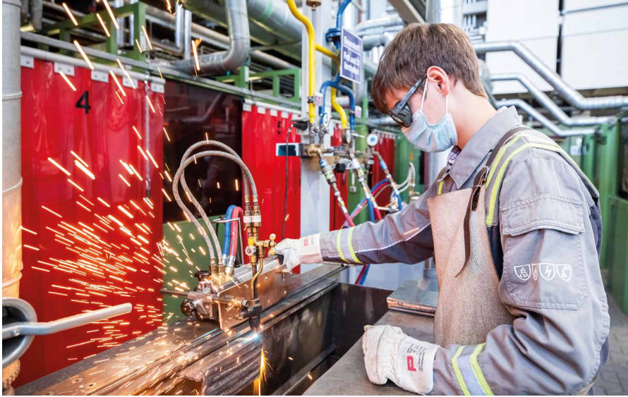
Anlagenmechaniker beim Brennschneiden
